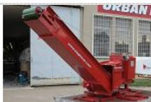
**La protezione da sovraccarico** Una cinghia antiscivolo protegge il dispositivo dal sovraccarico. Se viene inserito un ramo troppo forte, la cinghia sarà scivolata e il motore si fermerà. Se lo fanno, le lame del coltello di solito mordono il ramo e non possono essere rimosse liberamente dalla tramoggia. La leva fornita viene utilizzata per rilasciarlo. Rilasciare il ramo ruotando la leva in senso orario.
