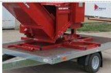
**La tramoggia di ingresso** La tramoggia è sufficientemente lunga da garantire sicurezza ed è dotata di un telaio di intercettazione di sicurezza che, premendo verso il basso, arresta
