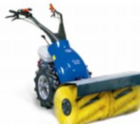
**STROJEVI ZA ČIŠĆENJE:** s usmerljivom četkom sa posebnim vlaknima, koja omogućuje primjenu pored općeg čišćenja i za odstranjivanje snijega.
