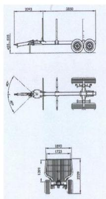
Potente e manovrabile il rimorchio PALMS 101 **con la portata di 11 tonnellate** e quasi 10 metri cubi del piano di carico si adatta ad un ampio spettro di utenza.
