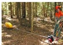
Installare una seconda pulleggia al carico. La fune passa dal verricello attraverso la prima pulleggia, poi la seconda pulleggia viene attaccata allo stesso albero della prima pulleggia. La potenza di trazione del verricello di 1 tonnellata è così raddoppiata a 2 tonnellate.
