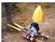
Attaccare il verricello all'albero di ancoraggio usando l'imbragatura di poliestere.
