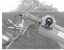
Bobina elettrica con cavo lungo 15 m e pulsante in cabina e presa accendisigari 12 V
