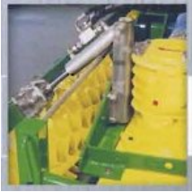
Nastavljanje hidravličnega valja
