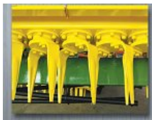
Paličasti valjak Radno telo sa dva noža
